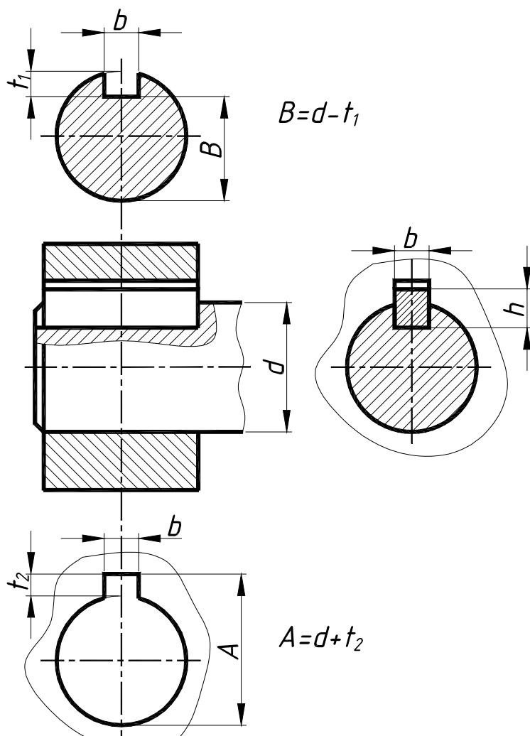
Размеры  $t_1$ ,  $t_2$ ,  $h$  берут по табл. 18 в зависимости от диаметра вала.
