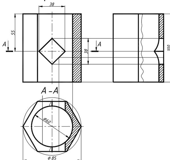
Рисунок 43 – Построение простых разрезов детали
