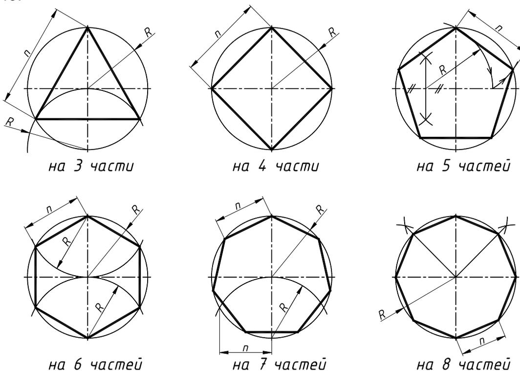
Рисунок 19 – Деление окружности на равные части
