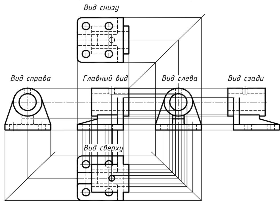
Рисунок 35 – Стандартные виды в проекционной связи
