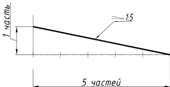
Рисунок 16 – Построение уклона 1:5
