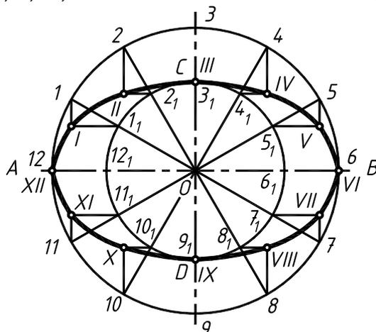
Рисунок 21 – Построение эллипса по большой и малой оси
