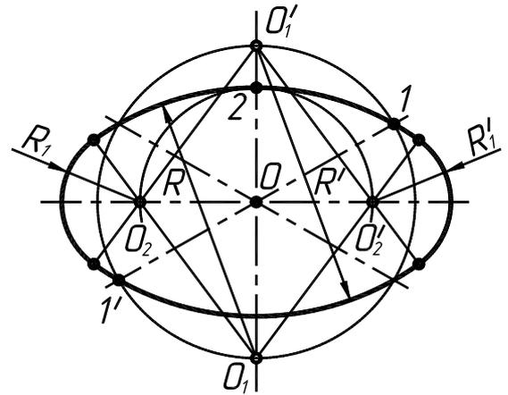
Рисунок 52 – Построение овала в плоскости XOY
