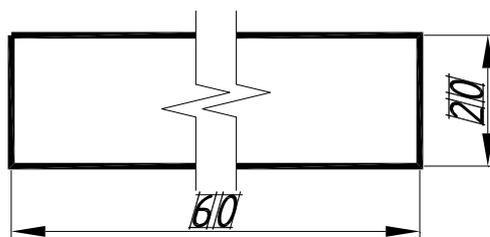
Рисунок 31 – Размерная линия изделия с разрывом
