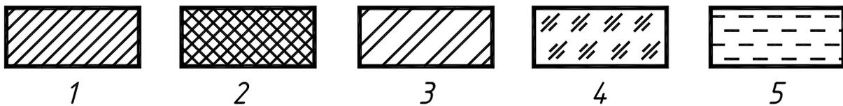
1 – металлы и твердые сплавы; 2 – неметаллические материалы; 3 – керамика и силикатные материалы для кладки; 4 – стекло и другие светопрозрачные материалы; 5 – жидкости
