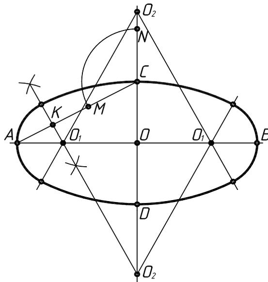
Рисунок 20 – Построение четырехцентрового овала
