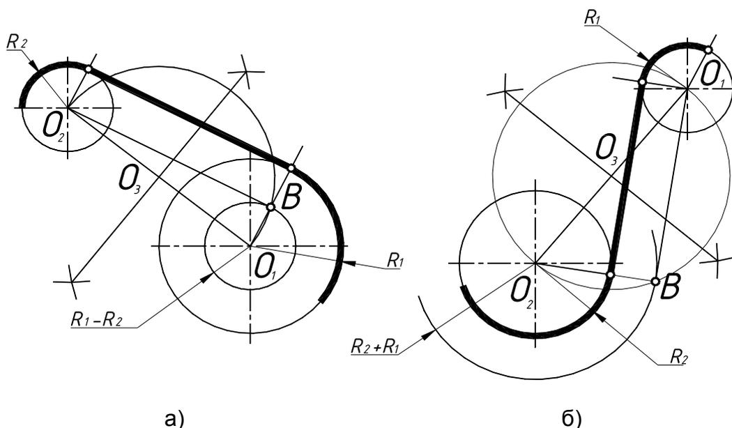
Рисунок 15 – Построение касательной к окружностям
