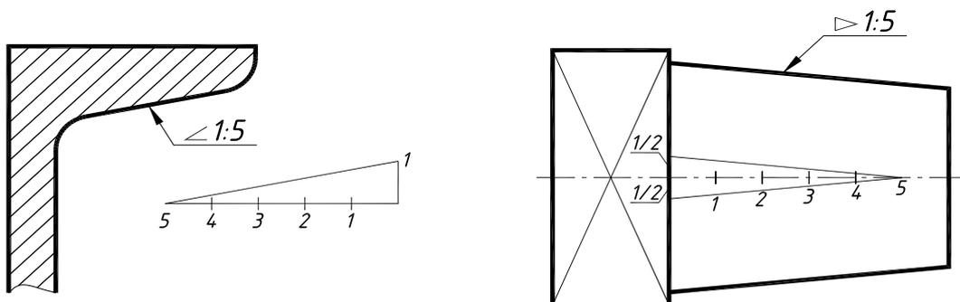
Рисунок 18 – Построение параллельных линий уклона и конусности
