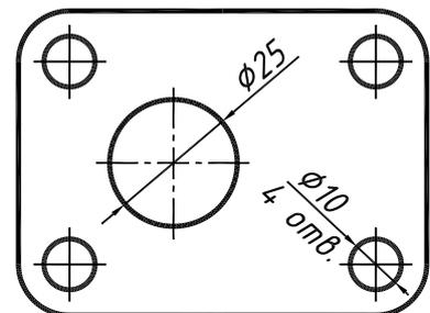
Рисунок 3 – Осевые линии окружностей
