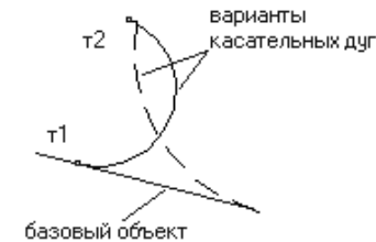
Рис. 8.106. Пример построения касательной к кривой
