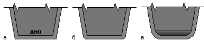
Рис. 7.70. Штамповка (поперечный разрез): а) без скругления ребер дна, б) с нулевым радиусом скругления, в) с радиусом скругления больше нуля
