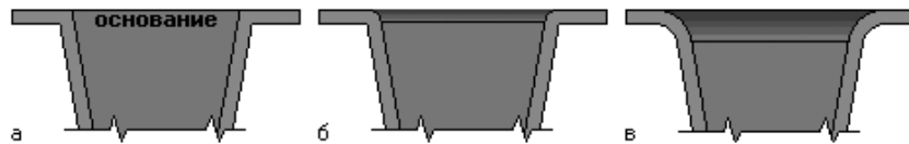
Рис. 7.69. Поперечный разрез штамповки (буртика): а) без скругления ребер основания, б) с нулевым радиусом скругления, в) с радиусом скругления больше нуля
