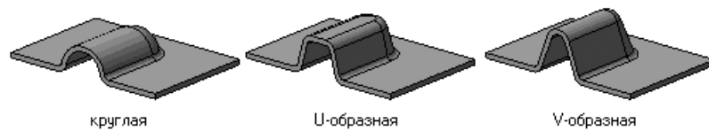
Рис. 7.89. Формы сечения буртика: круглая; U-образная; V-образная
