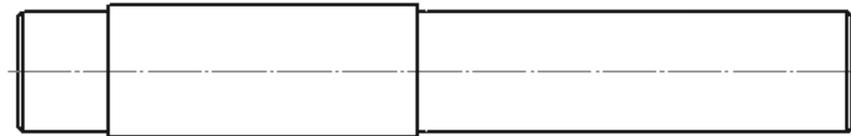
Рис. 4.100. Результат продления осевой линии за торцы вала
