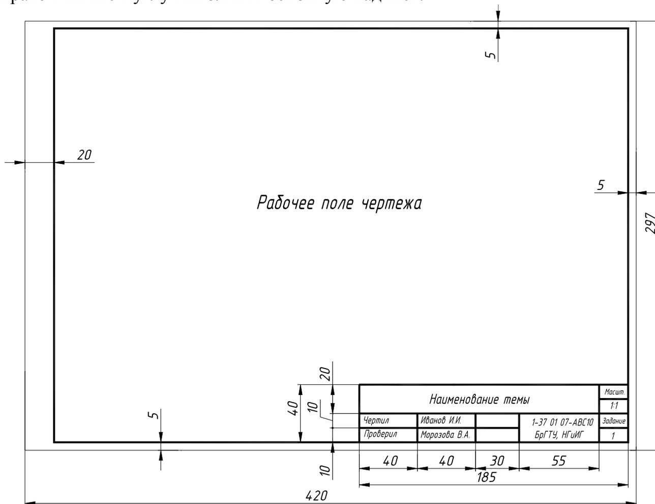
Рисунок 1 – Пример определения рабочего поля чертежа задания
